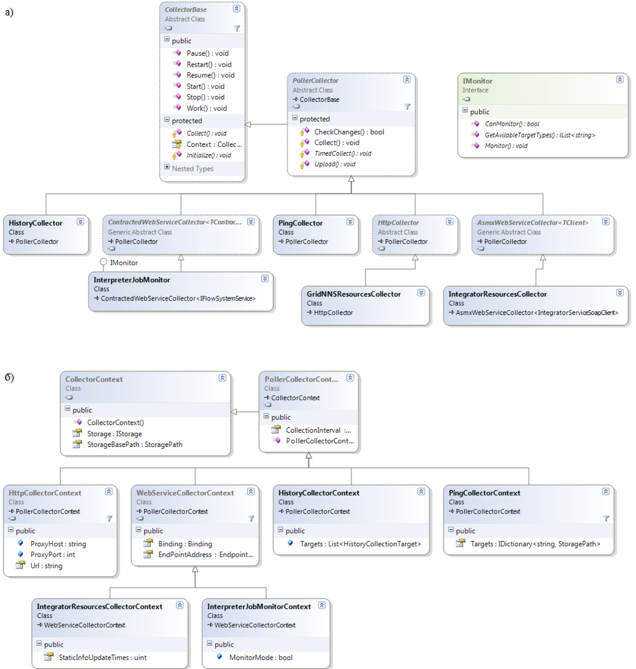
Рисунок 3.2 – Диаграмма классов сборщиков компонента мониторинга а) дерево наследования сборщиков, б) дерево наследования их контекстов
