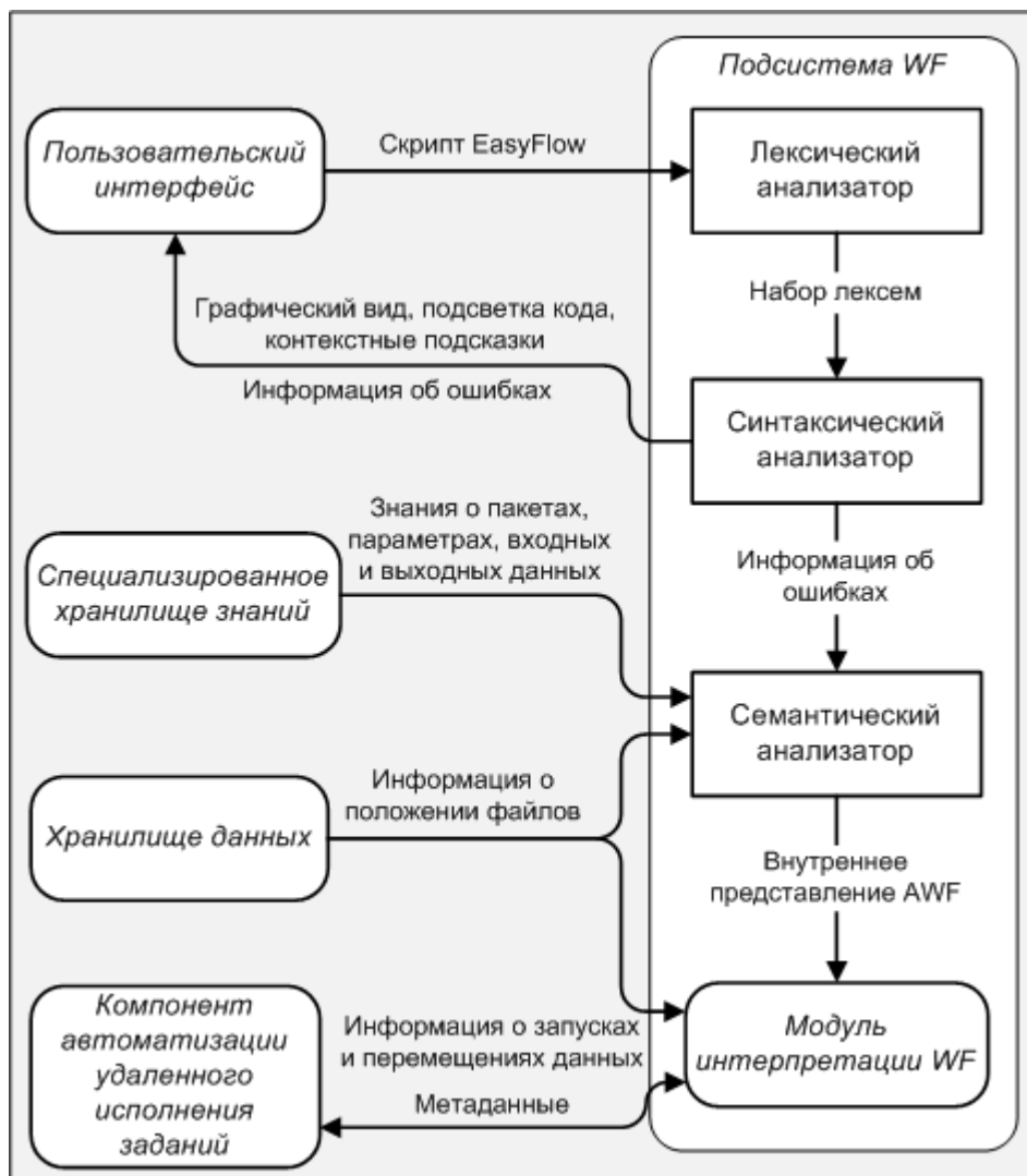
Рисунок 3.2 – Функциональная схема работы компонента формирования и исполнения WF
